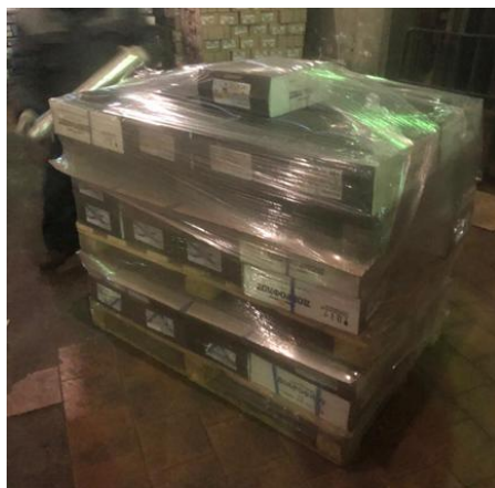
Рисунок 3. Формирование грузопакета ручным способом с использованием стретч-пленки. Фото авторов Figure 3. Manual formation of a cargo package using stretch film. Photo by the authors
