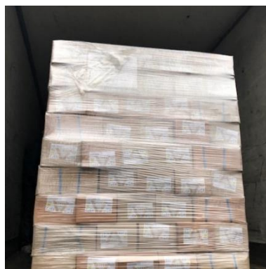
Рисунок 7. Паллет со стретч-пленкой (толщина 20 мкм) после испытания. Фото авторов Figure 7. Pallet with stretch film (20 \mu\text{m} thick) after testing. Photo by the authors
