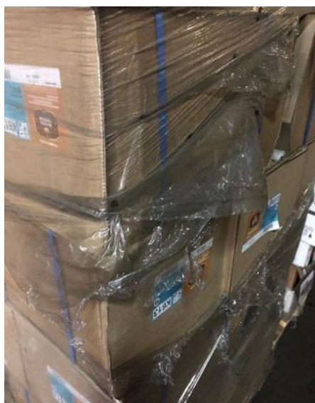
Рисунок 6. Разрывы стретч-пленки (толщина 15 мкм) в середине паллета при автоперевозке. Фото авторов Figure 6. Tears in stretch film (15 \mu\text{m} thick) in the middle of a pallet during road transport. Photo by the authors
